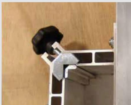
Die Steckfüße werden beim Aufbau in die dafür vorgesehenen Eckwinkel gesteckt und mit dem Handrad fixiert. Sie benötigen dazu keinerlei Werkzeug. Der flächenpressende Klemmkeil garantiert eine 100% sichere Standfestigkeit.
