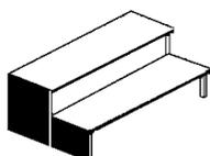
**Blende für Aufgangstreppe, aus Buche-Multiplexplatte, 15 mm stark, natur lackiert (mit 2K-PUR-Schicht-Lackierung in B1), aus Einzelelementen > 1 x seitlich an Treppe montiert**
