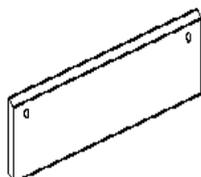
**Blende für Bühnenelement, aus Buche-Multiplexplatte, 15 mm stark**, natur lackiert (mit 2K-PUR-Schicht-Lackierung in B1), Blende plan mit Elementoberfläche
