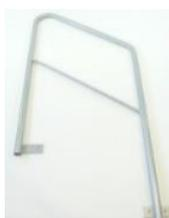
**Treppengeländer aus Stahlrohr, mit Knieholm**, aus Rundrohr, D=40 mm, mit angeschweißten Befestigungslaschen, rechts oder links, nach RAL 9005 tiefschwarz pulverbeschichtet, für Innenbereich
