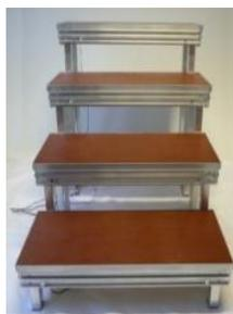
**Aufgangstreppe 100 cm breit, Auftritt 32,5 cm tief, aus einzelnen Bühnenelementen "Praktikus 750"**, einschl. Bühnenboden aus Buche-Tischlerplatte, 21 mm stark, Oberfläche mit B1 UV-Lack natur, mittelbraun oder schwarz beschichtet
