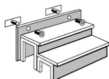
**Blende für Aufgangstreppe, aus Buche-Multiplexplatte, 15 mm stark, natur lackiert (mit 2K-PUR-Schicht-Lackierung in B1), ca. 100 cm breit > Blende vorne und hinten an Treppe montiert**
